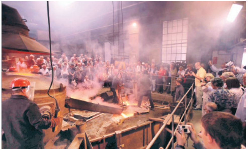
Rechts: Rauchscheiden steigen von der glühend heißen Glockenschmelze auf, die über einen Kanal in die vorgefertigte Form fließt.
